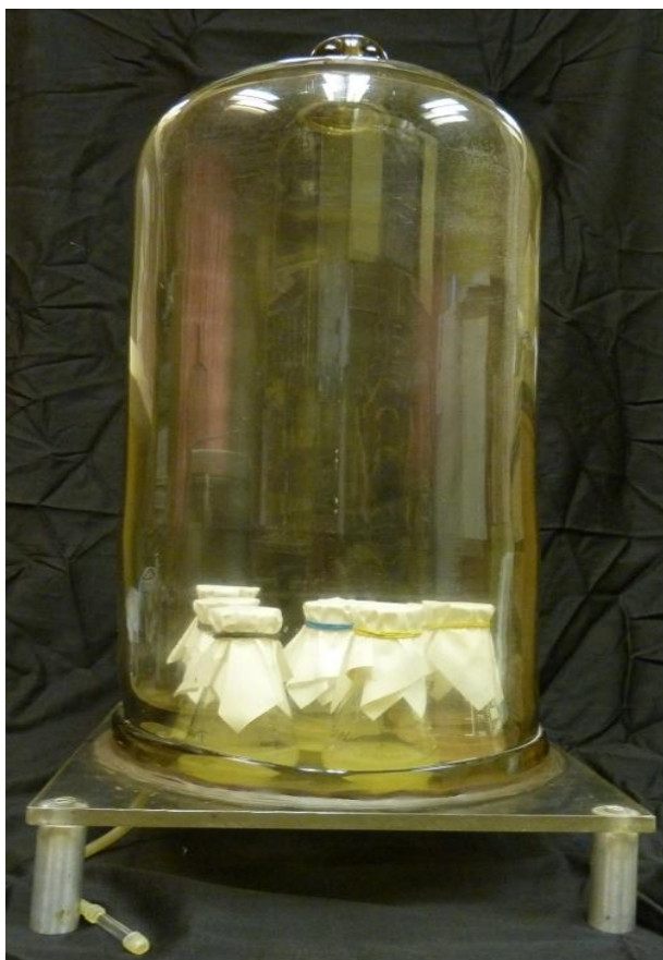
Рис. 14. Газовый колокол для культивирования суспензионной культуры A. thaliana в атмосфере экзогенных газов.
