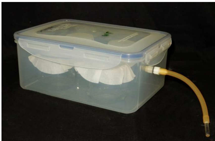
Рис. 15. Контейнер для культивирования суспензионной культуры A. thaliana в атмосфере экзогенных газов.
