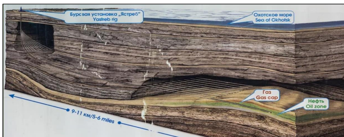
Рис. 26 - Схема бурения с большим отходом от вертикали с БУ «Ястреб»
