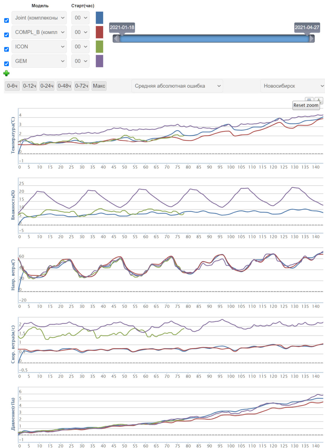
Рисунок Б.8 – Пример сравнения средних абсолютных погрешностей прогнозов, в том числе по предлагаемому комплексному прогнозу (обозначен как COMPL_V, красные кривые) на сайте «Погода для специалистов» https://special.meteoinfo.ru/ в разделе «Мониторинг качества прогнозов» (администратор сайта А.В.Смирнов)
