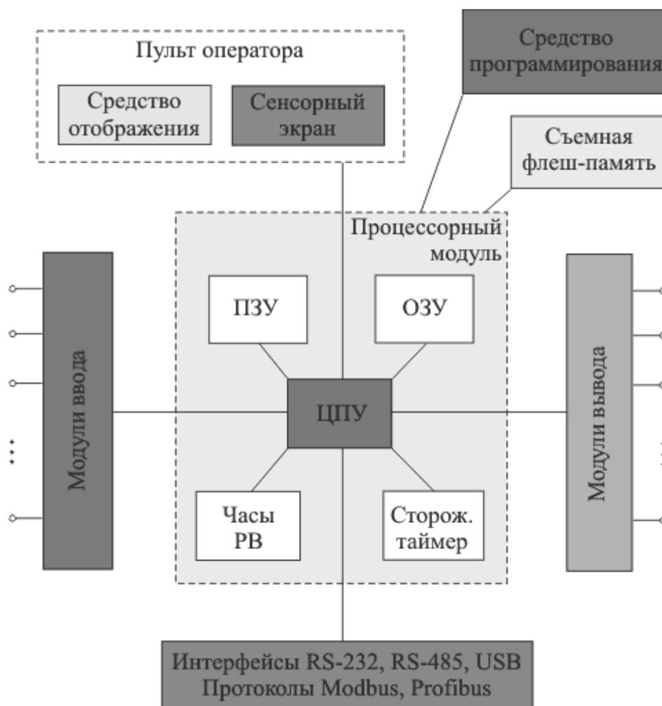
Рисунок 1.7 Типовая архитектура PLC
