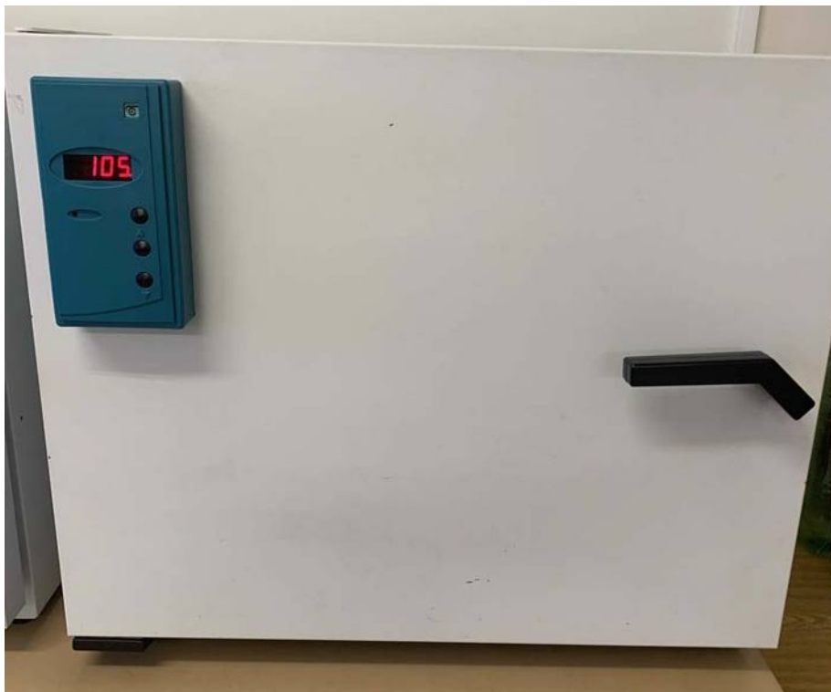
Рисунок 3.4 – Сушильный шкаф ШС-80-01-СПУ.
