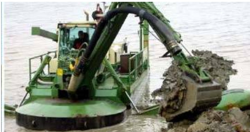
Рисунок 1.5 – Экскаваторный способ добычи сапропеля.
