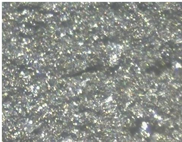
Рисунок 4.8 – Микроструктура вольфрамового образца после облучения: a – зона 1; б – зона 2; в – зона 3 ( \times 200 )
