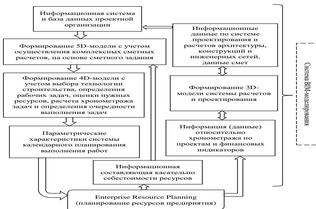
Рисунок 3.8 - Интеграция системы ERP и BIM-моделирования при разработке проектов по синхронизации инфраструктуры морского и ж/д транспорта (составлен автором по материалам источника [15])
