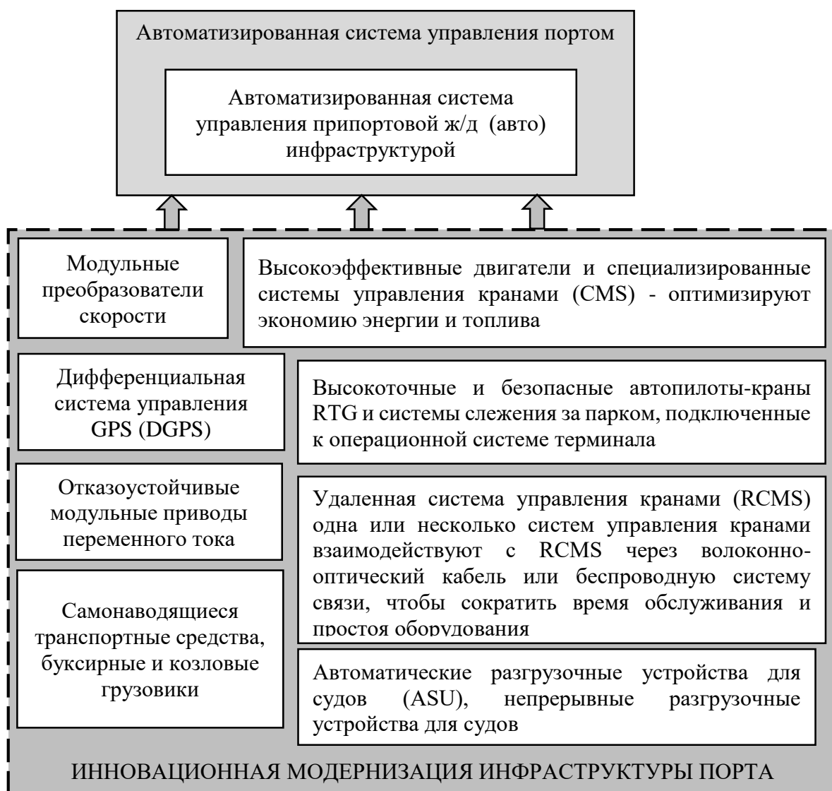
Рисунок 3.11 - Схема модернизации портовой инфраструктуры для последующего формирования системы «АСУ в АСУ» (разработан автором)
