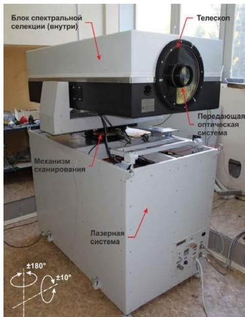
Рисунок 16 – Общий вид опытного образца лидарного обнаружителя паров ВВ
